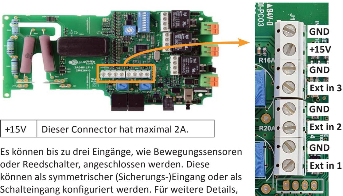
Es können bis zu drei Eingänge, wie Bewegungssensoren oder Reedschalter, angeschlossen werden. Diese können als symmetrischer (Sicherungs-)Eingang oder als Schalteingang konfiguriert werden. Für weitere Details, siehe *Funktionseinstellungen* (S. 38).
