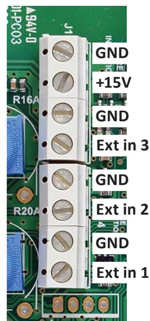
Jusqu'à trois entrées comme des détecteurs de mouvement ou des contacts en ampoule peuvent être raccordés. Elles peuvent être configurées en tant qu'entrées symétriques (sécurité) ou d'interrupteur. Voir *Réglages fonctionnels* (p. 28) pour plus de détails.
