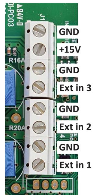
Op til tre indgange såsom bevægelsesfølere eller reed-kontakter kan tilsluttes. Disse kan konfigureres som balancerede indgange (sikkerhed) eller kontaktindgange. Se *Funktionelle indstillinger* (side 48) for yderligere oplysninger.
